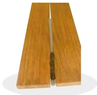
Cordone in schiuma di polietilene a cellule chiuse e di sezione circolare per il prierimpimento di giunti di dilatazione da riempire successivamente con Elastoxyl.
